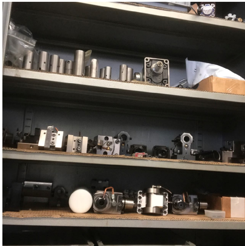
Accessori macchina ( 10 utensili motorizzati , 10 portautensili fissi , portapinza supplementare per mandrino principale , serie di pinze , riduzioni boccole , ecc..) – Ancillary equipment for lathe ( supplementary BELLEGRANDI collet Holder , set of collets , bush , reduction sleeves , etc.) – Equipement supplémentaires pour tour ( portepince supplémentaire BELLEGRANDI. Canons , bagues , pincas , etc ) – Zubehör für Drehmaschinen (zusätzlicher BELLEGRANDI Spannzangenhalter, Spannzangensatz, Buchse, Reduzierhülsen usw.)
