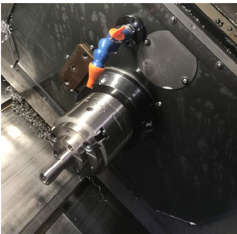
Mandrino con portapinza HAINBUCH – Main Spindle with HAINBUCH collet Holder – Broche avec porte pince HAINBUCH – Hauptspindel mit HAINBUCK Spannzangenhalter
