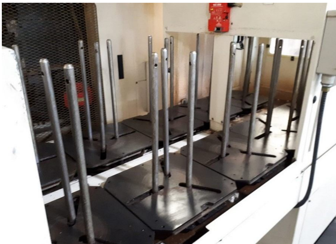
Magazzino automatico – Automatic stocker – Magasin automatique – Automatische stocker Robot a portale a doppia mano di presa – Double hand Gantry robot – Portique a double main de prise - Doppelhand Portalroboter
