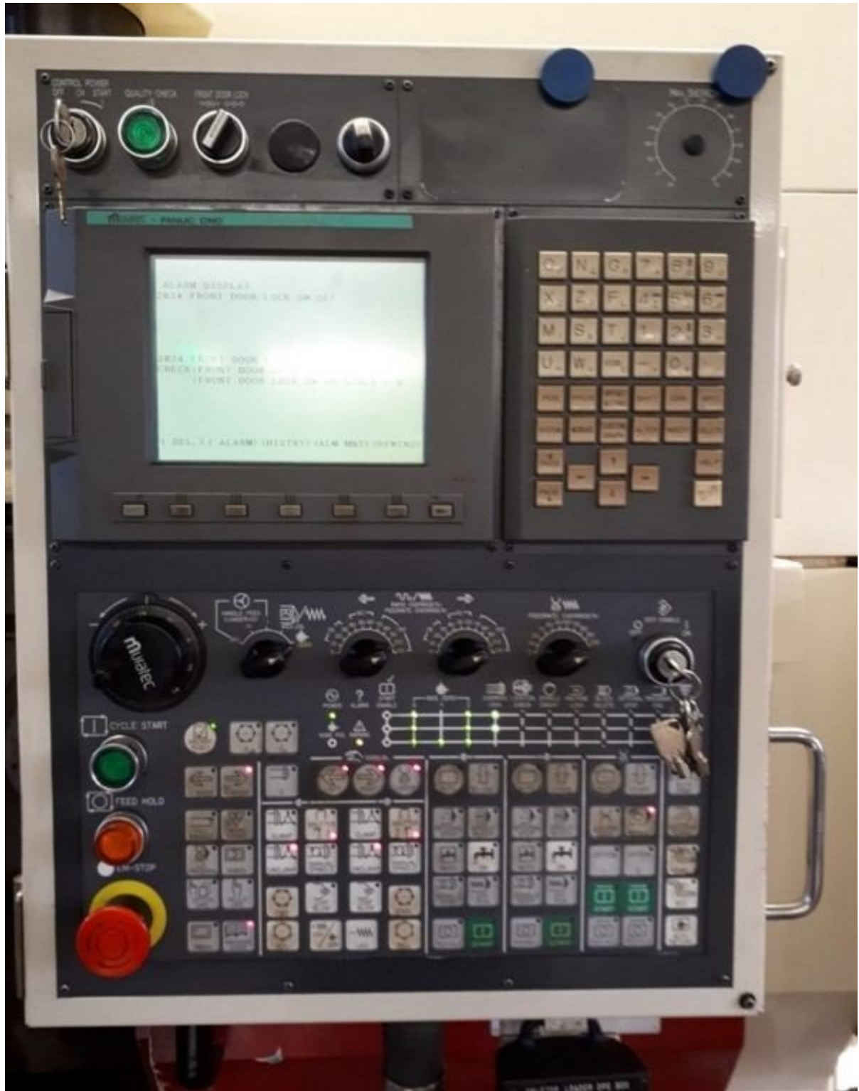
Unità di Governo FANUC FS 18i-TB – FANUC FS 18i-TB CNC unit – Commande Numérique FANUC FS 18i-TB – FANUC FS 18i-TB Steuerung
