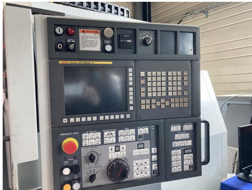
Unità di Governo FANUC 32i-B – FANUC 32i-B CNC unit – Commande Numérique FANU 32i-B– FANUC 32i-B Steuerung
