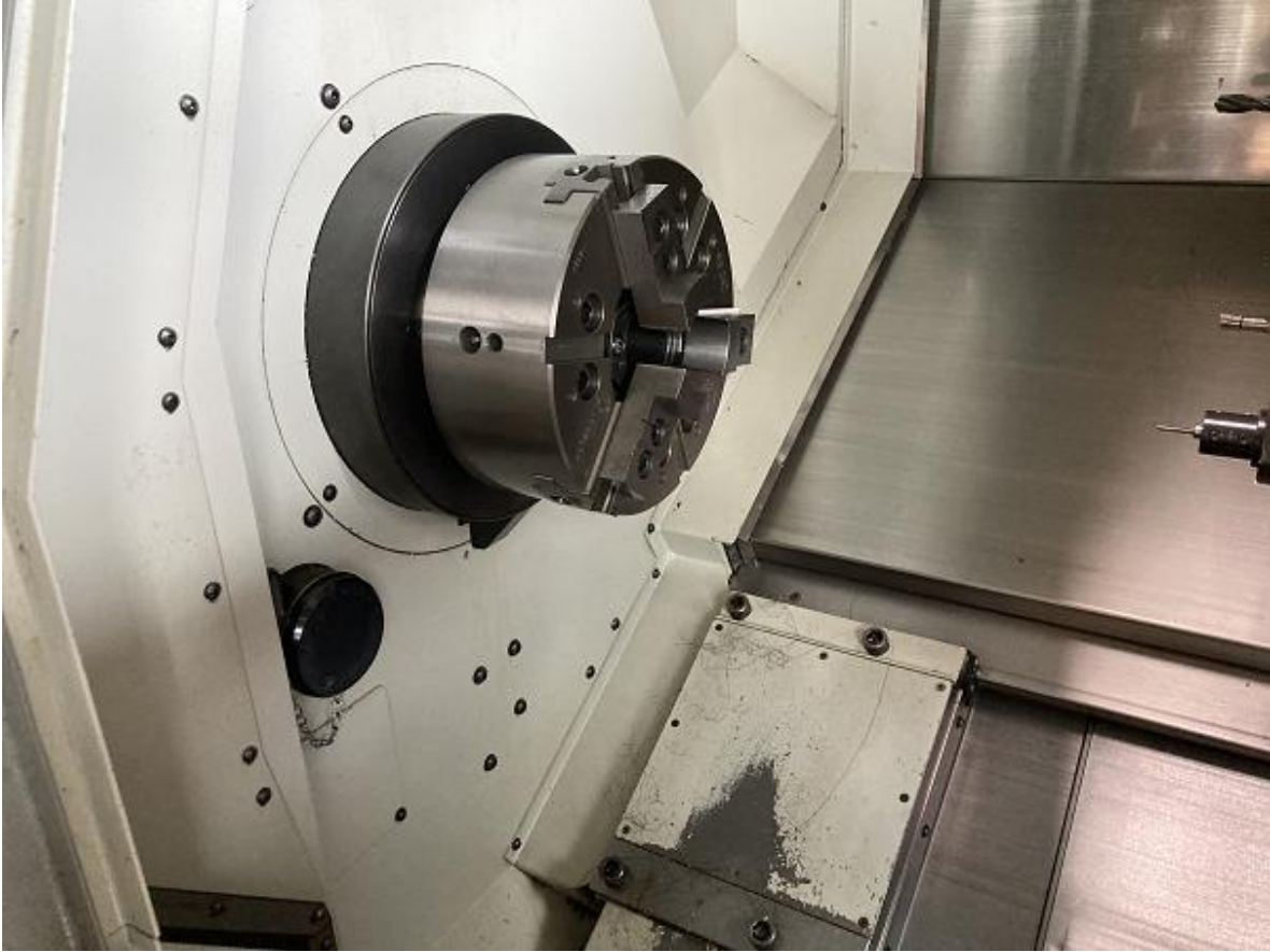
Mandrino con autocentrante – Main Spindle with chuck – Broche avec mandrin – Hauptspindel mit Spannfutter
