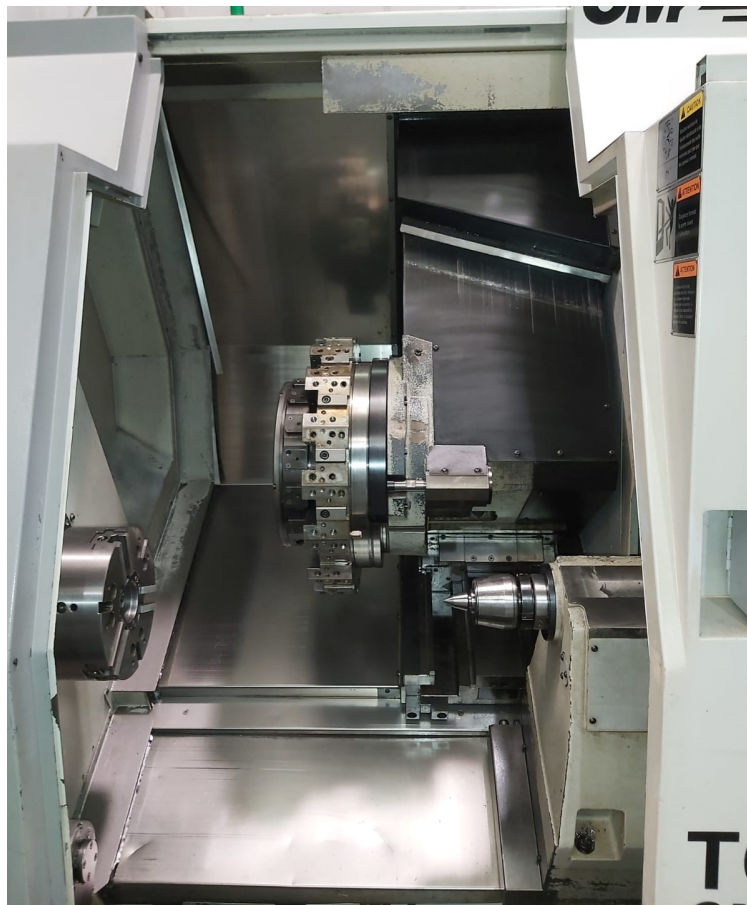
Torretta a 16 posizioni rotanti , Potenza 16 kW, con asse Y – 16 position Llive tool turret with Y axis. Driven tool power 16 kW – Tourelle a 16 positions avec outils tournantes et axe Y . Puissance outils tournantes 16 kW– 16 positionen agetriebene werkzeuge Werkzeugrevolver. Angetriebene werzeuge Leistung 16 kW
