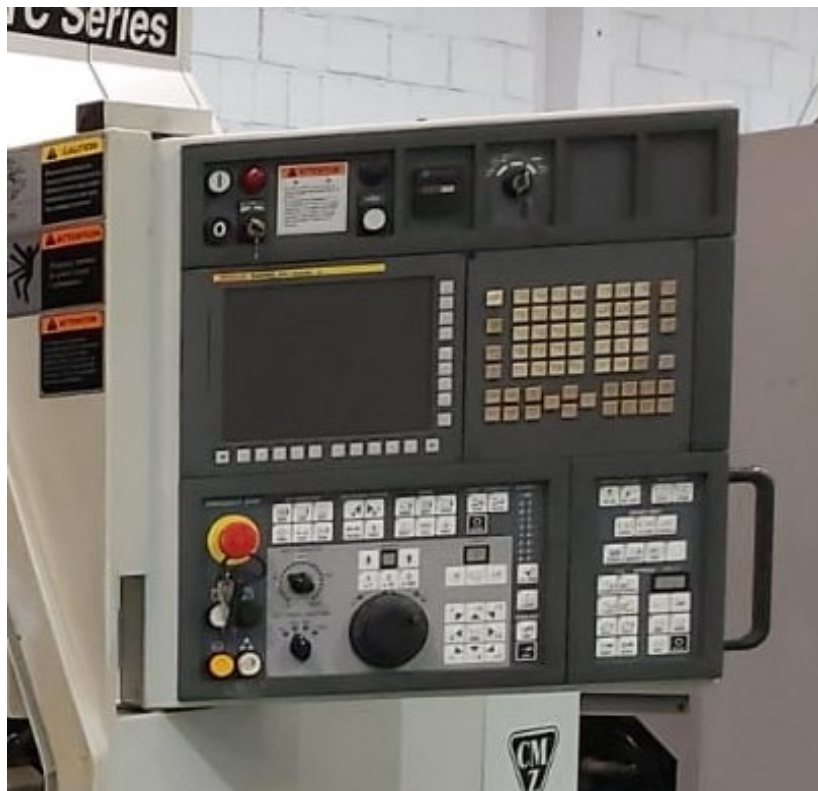
Unità di Governo FANUC 32i-B – FANUC 32i-B CNC unit – Commande Numérique FANUC32i-B– FANUC 32i-B Steuerung
