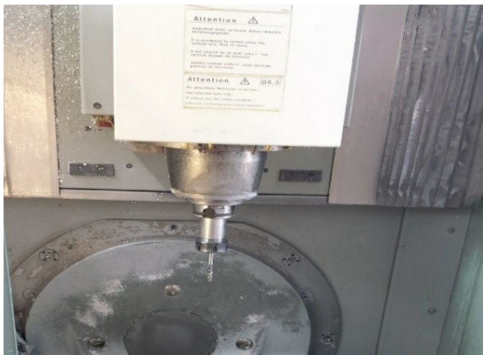
Testa verticale a 10.000 g/min – 12.000 rpm Vertical Milling head – Tete a fraiser Horizontal– Vertical à 12.000 trs/min - Vertikales Frasenkopf Drehzahlbereich 12.000 U/min
