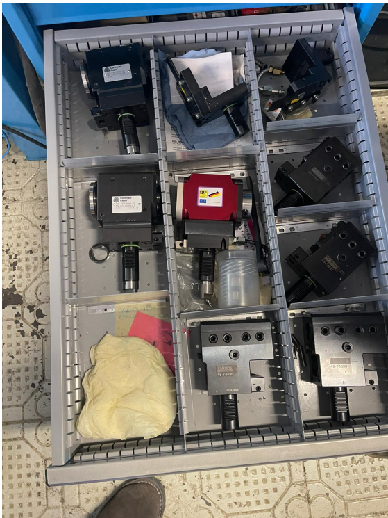
Utensili motorizzati e portautensili fissi e portapinze – Live and steady tools modules and collets – Outils fixes et tournants avec portepinces – Angetriebene un statische werkzeugen mit Futter
