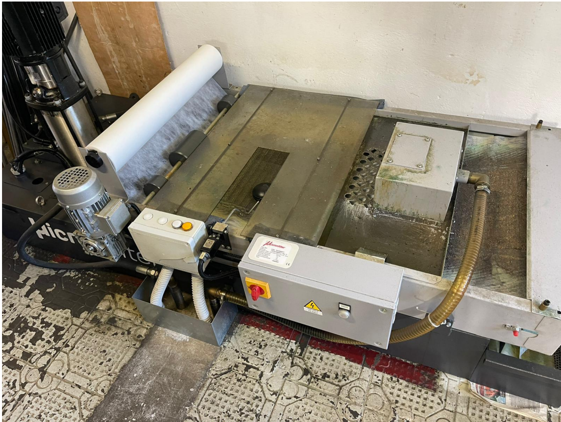
Filtro a carte 50 micron – 50 microns paper filter – Filtre a papier à 50 micron – 50 micron Papierenfilter
