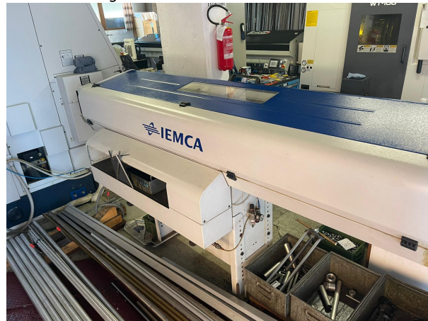
Alimentatore di barre IEMCA BOSS 21-E – IEMCA Bar Feeder type BOSS 21-2 . Embarreur IEMCA BOSS 21-E IEMCA Stangenlader Typ BOSS 21-E
