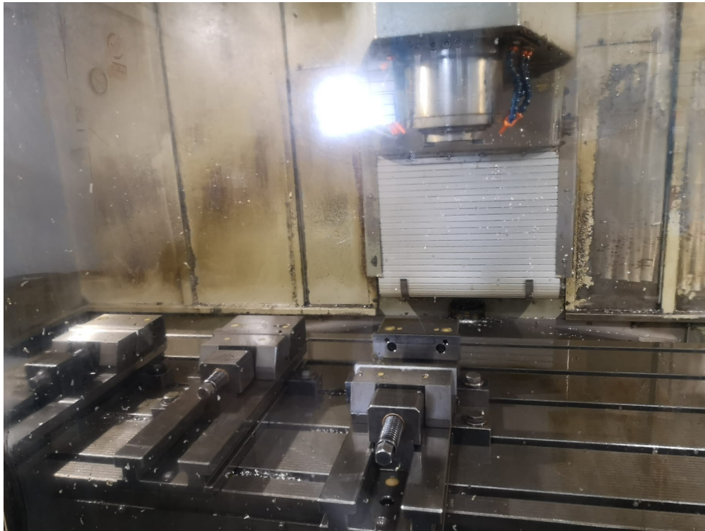
Zona di lavoro – Working area – Zone de travail – Arbeitsbereich Cambio utensili a 21 posti – 21 tools position tool magazine – Entrpot d'outils a 21 postes – 21 positionen Werkzeugwechsler
